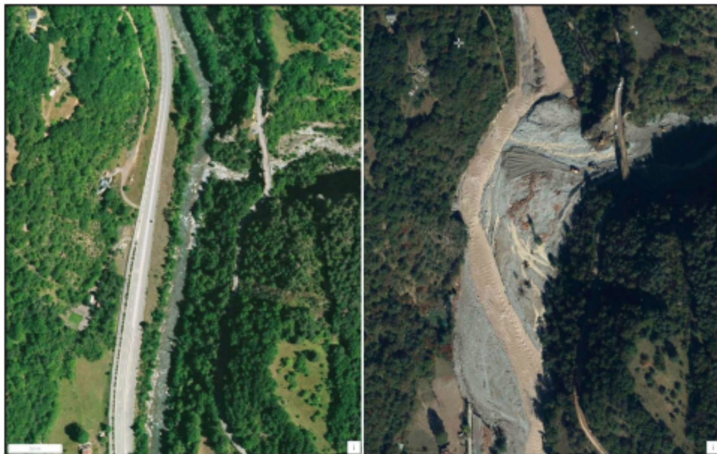
Photos 2 - Vallée de la Tinée au vallon d'Ullion (commune de Marie) : voie à double sens défoncée et recouverte par le cône de déjection lui-même recoupé par la Tinée.
